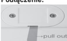
Najpierw usuwamy plastikowy pasek z pojemnika na baterie z tyłu licznika, zgodnie z rysunkiem. Instalowane baterie 2x 1,5V (LR44/AG13) służą do zasilania pamięci licznika.
