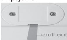
Najprv odstráňte plastový prúžok z batériového priestoru na zadnej strane merača, podľa obrázku. Inštalované batérie 2x 1,5V (LR44/AG13) slúžia pre napájanie pamäte merača. Potom pripojte merač do elektrickej siete 230 V~ a k meraču zatial nepripájajte žiadny spotrebič. Ak sa na displeji merača nezobrazia žiadne údaje alebo sú zle čitateľné, stlačíte
